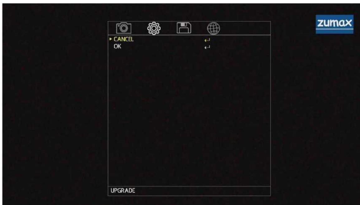
**СПОСОБ ОБНОВЛЕНИЯ:** убедиться, что обновляемый файл скопирован в корневой путь флэш-накопителя USB. Вставить флэш-накопитель USB в порт USB микроскопа. Перейти в Настройки (Settings) для запуска обновления встроенного ПО.
