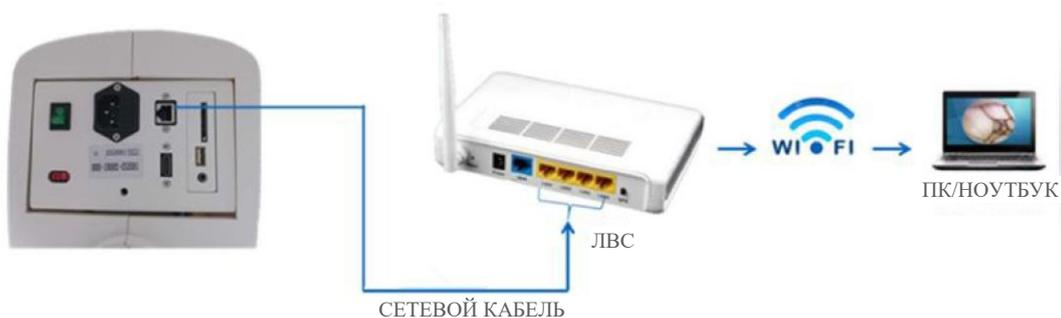
Подключить микроскоп к маршрутизатору с помощью сетевого кабеля.
