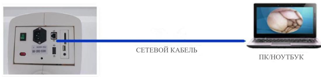
Подключить микроскоп к ПК/ноутбуку с помощью сетевых кабелей.
