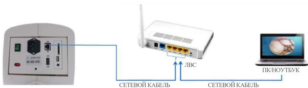
Подключить микроскоп и ПК/ноутбук к маршрутизатору с помощью сетевых кабелей.
